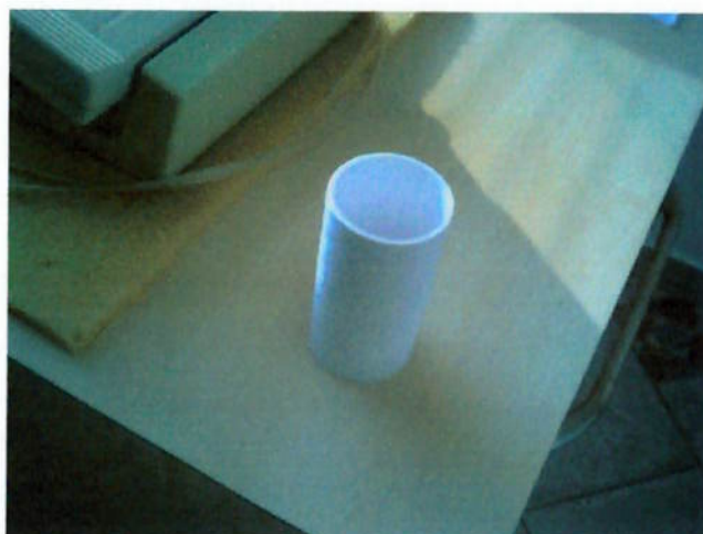
Fig. 47: Detalhe do bocal de papelão utilizado no teste no consultório
